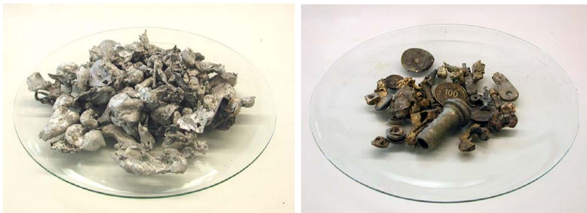
Abbildung 4-3: Aus der Schlacke zurück gewonnene Metallfraktionen: links Aluminium – rechts Messing. Die Metalle sind „blank“: Sie haben keine Schlackenanhäufungen.
